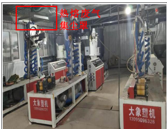
单翼迷宫式滴灌带生产线
