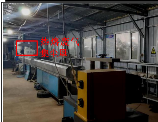
园林绿化管生产线（PE 实壁管）
