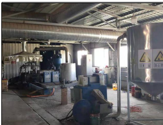
再生塑料颗粒生产线
